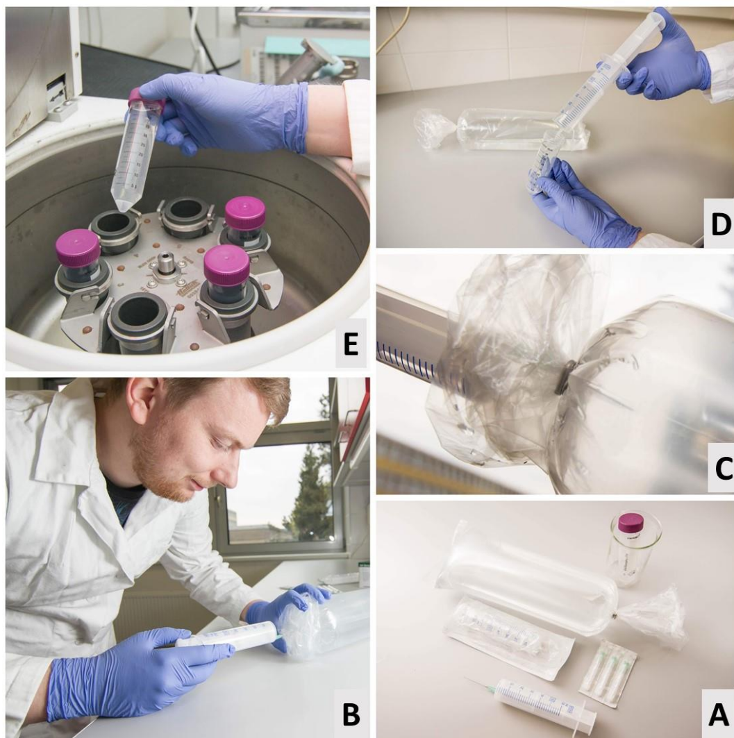
Obr. 10. Odběr vzorku vody a jeho koncentrace. A – hermeticky uzavřený polyetylenový pytel s vodou injekční stříkačka, jehla a 50 ml kónická falkonka; B – odběr vody z polyetylenového pytle; C – detail odběru vody skrz sponu pomocí jehly; D – přestříknutí vzorku vody do falkonky; E – vkládání falkonek se vzorkem vody do centrifugy
